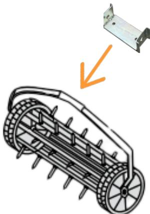
3. A continuación, coloque el adaptador de acero en la parte superior del aireador. Asegúrelo en su lugar con las tuercas y tornillos proporcionados.
