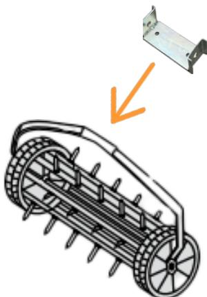
3. Successivamente, posizionare l'adattatore in acciaio sul lato superiore dell'aeratore. Fissarlo in posizione con i dadi e i bulloni forniti.
