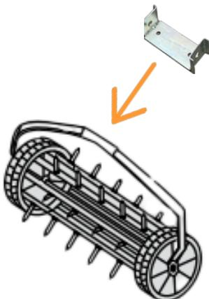
3. Als Nächstes platzieren Sie den Stahladapter auf der Oberseite des Rasenlüfters. Befestigen Sie diesen mit den mitgelieferten Muttern und Schrauben.
