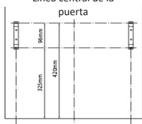
Vista en la parte trasera de la puerta Grosor del gabinete de 18mm
