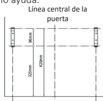
Vista en la parte trasera de la puerta Grosor del gabinete de 19mm
