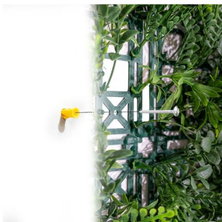
Installez la cheville murale sur la surface à laquelle vous souhaitez fixer le mur végétal artificiel. Vissez le carreau mural à la cheville en utilisant les vis pour sécuriser le carreau à travers les trous dans le treillis du carreau mural.
