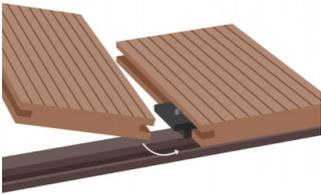
3. Beginnen Sie mit der Verlegung Ihrer Terrassendielen an der Außenseite des zu belegenden Bereichs. Platzieren Sie Ihre erste Diele und schrauben Sie es mit einer Reihe von Starterclips in jeden Balken, den es kreuzt. Setzen Sie dann die T-Clips in die Rille an der Seite der Diele ein und schrauben Sie sie mit den mitgelieferten Schrauben in jeden Stützbalken, einen T-Clip für jeden Stützbalken.
