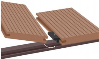
3. Empiece a colocar los tableros en el exterior del área que se va a entarimar. Coloque su primer tablero y fíjelo en cada vigueta con la que cruce usando una fila de abrazaderas metálicas. A continuación, coloque los clips en T en la muesca a lo largo del borde del tablero y atorníllelos en cada vigueta con los tornillos suministrados. Cada vigueta tiene un clip en T.
