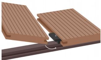
3. Commencez à poser les lames en bordure de la terrasse. Positionnez la première lame et vissez-la dans chaque lambourde qu'elle croise en utilisant une série de clips de début et fin. Ensuite, insérez des clips en T dans la rainure le long du bord de la lame et vissez-les dans chaque lambourde avec les vis fournies. Il faut un clip en T pour chaque lambourde.
