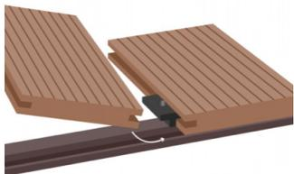
3. Iniziare a posare le assi del piano di calpestio all'esterno dell'area da rivestire. Posiziona la tua prima tavola e avvitala in ogni travetto che attraversa utilizzando una serie di fermagli di avviamento. Quindi inserire i T-Clips nella scanalatura lungo il lato della scheda e avvitarli in ciascun travetto di supporto con le viti fornite, una T-Clip per ciascun travetto di supporto.
