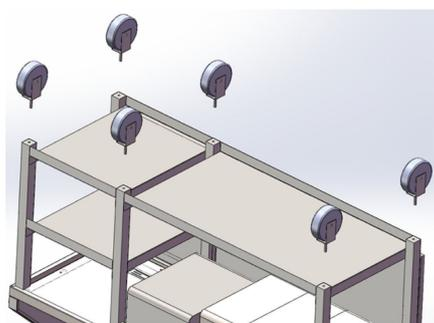
Atornille las ruedas en los agujeros en la parte inferior de las patas de la Estación de Barra de Cócteles Móvil.
