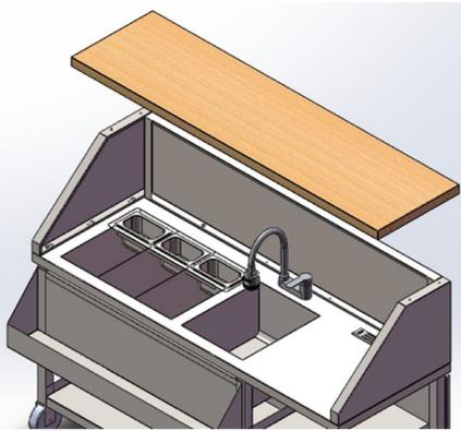
Verwenden Sie die M6\*20 Sechskantschrauben, um die Arbeitsplatte der Barstation an den unterstützenden oberen Paneelen zu befestigen, und schrauben Sie, bis die Platte sicher an der mobilen Cocktailbarstation angebracht ist.
