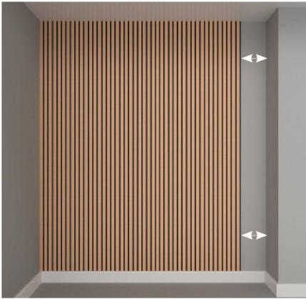
Repita el procedimiento anterior para todos los paneles de ancho completo restantes. Cuando llegue al final de la serie, puede ser necesario cortar el último panel al ancho correcto. Mida la distancia desde el borde del panel hasta la pared, en la parte superior e inferior, para verificar que esté paralelo.
