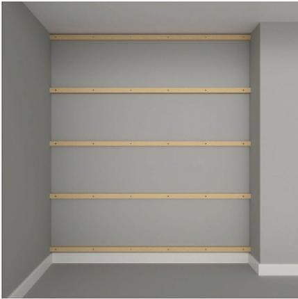
Perfore y fije de manera segura cinco listones (45mm x 45mm) a la pared, espaciados uniformemente. Tiene la opción de instalar lana mineral entre los listones para mejorar el aislamiento y aumentar la absorción de sonido.
