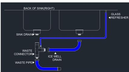
Fixez le rafraîchisseur de verre, le drain du puits à glace et le tuyau d'évacuation au connecteur de déchets. Ensuite, fixez le connecteur de déchets au drain de l'évier, en serrant fermement pour éviter les fuites.
