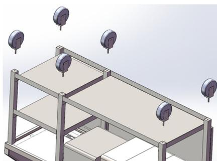
Avvitare le ruote nei fori sul lato inferiore delle gambe della Stazione Mobile per Cocktail.
