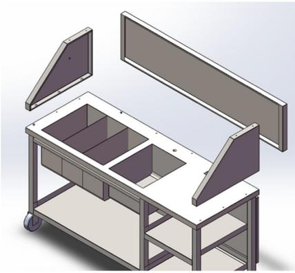
Utilizzando le viti esagonali M6\*20, fissare i pannelli superiori alla Stazione Mobile per Cocktail. Stringere le viti fino a quando non si sentono sicure nei raccordi.
